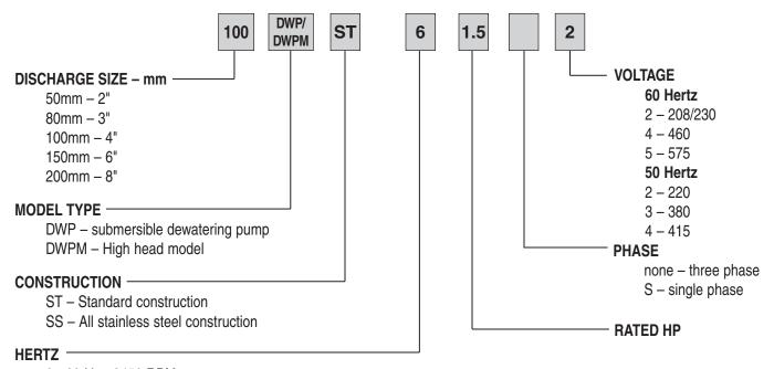
6 - 60 Hz 3450 RPM 5 - 50 Hz 2800 RPM
